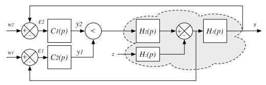
On règle les deux boucles indépendamment. On s'assurera de la mise hors service du sélecteur lors du réglage de chacune des boucles.
