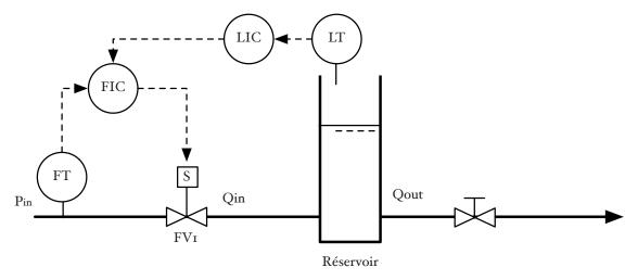
On observe ci-après l'évolution du niveau en réponse à une variation de la pression Pin. L'influence de cette même perturbation a été observée pour une boucle simple et une boucle cascade. L'apport de la cascade est sans équivoque.
