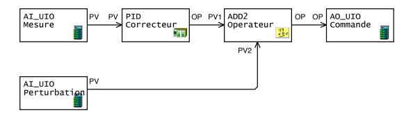
La boucle est composée de deux mesures (grandeur réglée et perturbation), d'un correcteur PID, d'un additionneur (ADD2) et d'une sortie.
